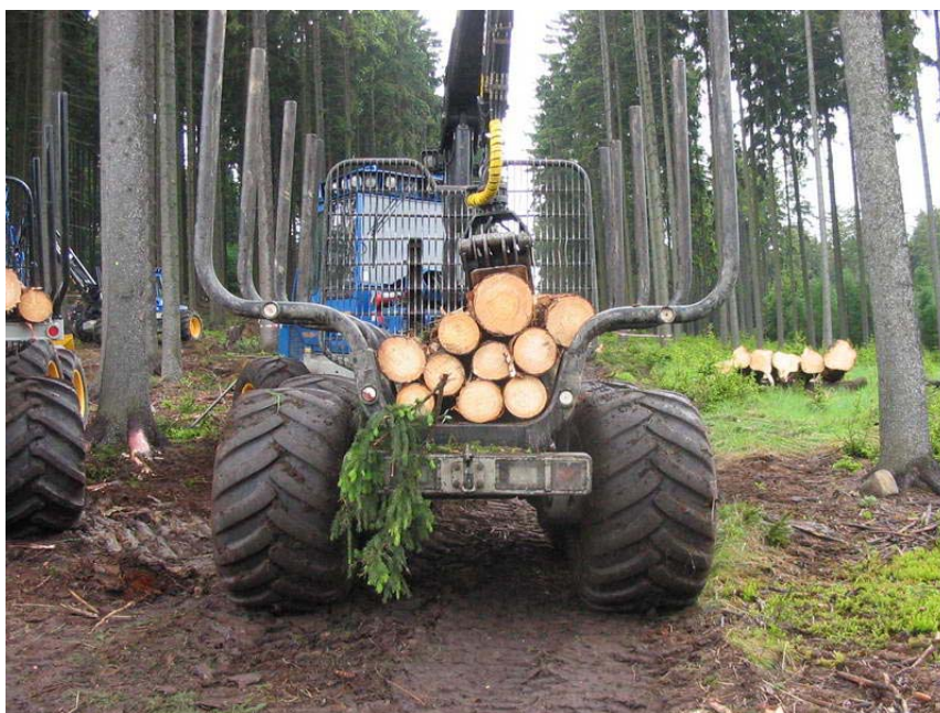
Obr. 5: Na podmíněně únosných (příp. neúnosných) půdách nezabrání ani osm pneumatik o šířce 700 mm vzniku kolejí (foto Z. Bartoš 6/06)
