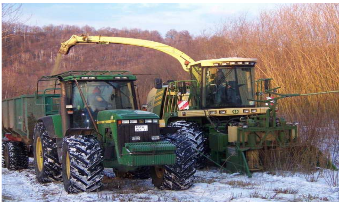
Obr. 13: Claas Jaguar upravený pro sklizeň RRD
